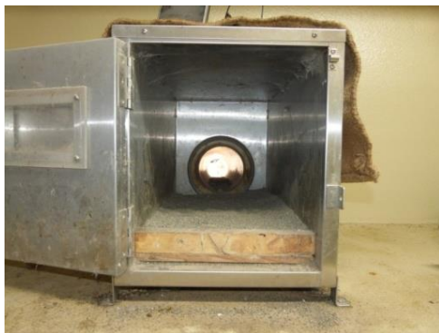
図.6 砂を敷き詰めた状態
